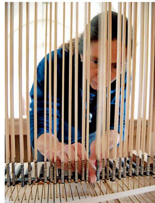
Cu precizie de ceasornicar, elvețianca Barbara Dutli conectează claviatura la sistemul de transmisie, compus din patru serii consecutive de pârgii.
